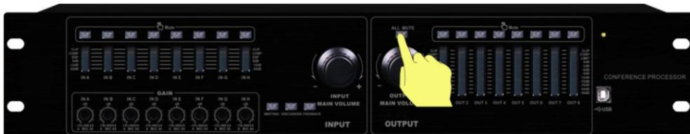
按下面板示意图的全静音键，输出通道全部静音。
