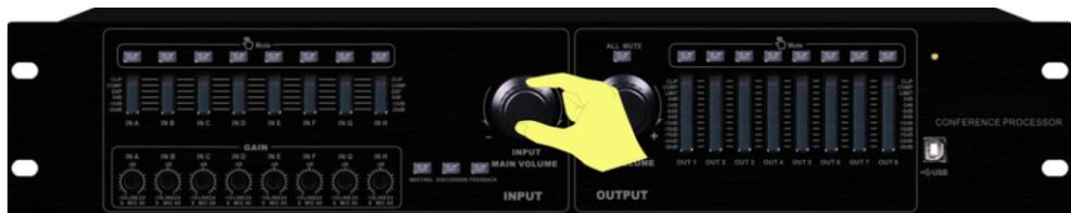
顺时针旋转面板示意图3的输入总音量旋钮，对应输入通道音量增大，逆时针旋转输入总音量旋钮，对应输入通道音量减小。
