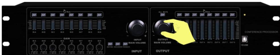
顺时针旋转面板示意图的输出总音量旋钮，对应输出通道音量增大，逆时针旋转输出总音量旋钮，对应输出通道音量减小。
