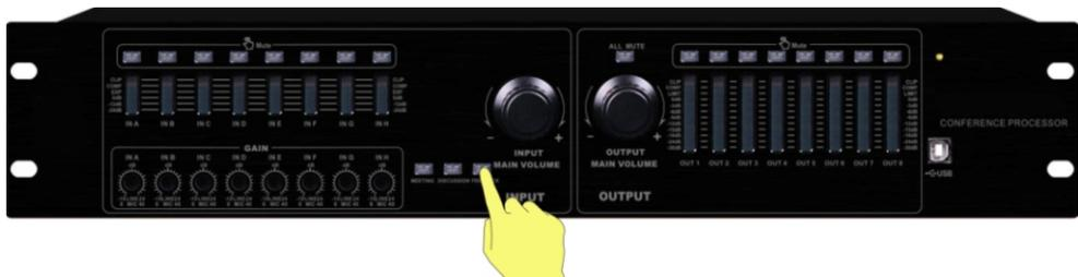
选择会议模式后，可以选择是否开启反馈抑制功能，按下按键，反馈抑制开启，再次按下，关闭反馈抑制。
