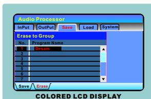
选择要擦除的程序保存位置，编码开关确认后程序即被擦除，擦除后程序名为空，默认程序数据为出厂数据，出厂默认数据详见报告，程序擦除后会有擦除成功提示，请按确认，图示如下。
