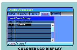
选择要调用的程序的位置，编码开关确认后程序即被调用，调用后会有个调用进度条显示，图示如下。
