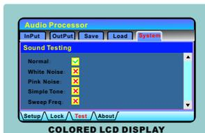
系统开机后默认关闭所有信号发生器，在音频测试界面你可以选择白噪声（白噪声发生器：增益：-60dB+6dB、步距为0.1dB），粉噪声（粉噪声发生器：增益：-60dB+6dB、步距为0.1dB），单频点声（纯音发生器：增益：-60dB+6dB、增益步距为0.1dB，频点步距为1Hz），扫频声（扫频模式：增益：-60dB+6dB、步距为0.1dB，周期：2s-30s）。
