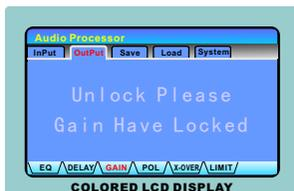
功能锁提示(INPUT 或 OUTPUT)：上面的“功能锁”内容没有保存在机器和PC软件中，它只修改当前数据组；同时在调用数据到当前组时它亦会被调用的数据修改；选择打“√”的功能在当前数据组中将被锁住不可以修改，同时当前数据组中您将看不到改功能的参数值和状态值；保存数据时，“功能锁”信息自动保存到该数据中，下次调用时，已设置被锁住的功能将不能解锁；机器中没有名字的数据组为默认工厂数据，所有功能都没有锁住。如果调用默认工厂数据到当前组，则功能锁会全部被自动重置为“无锁”状态；“功能锁”中只要有任意1个或以上的功能选择锁住，则PC界面中的“报告”功能就会同步被锁住。
