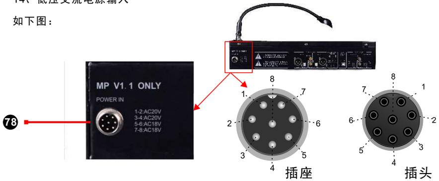
78--电源输入12(20V~)、34(20V~)、56(18V~)、78(18V~)
